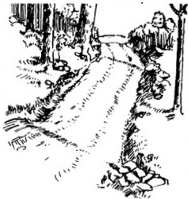
Obrázok 11 Odvodňovanie nevyužívaných zväžnic pomocou priečných zníženín.
